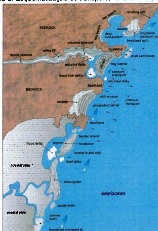
Figura 2: Esquematisação do transporte de minerais pesados
